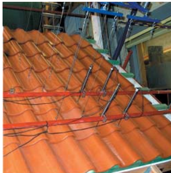
Panhakentest uitgevoerd conform de norm prEN14437, uitgevoerd in de laboratoria van TNO Bouw in Delft
